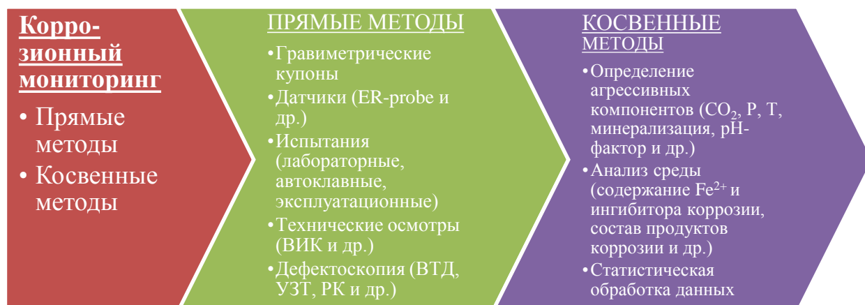
Рисунок 7. Схема с основными методами мониторинга газопроводов в агрессивных условиях
